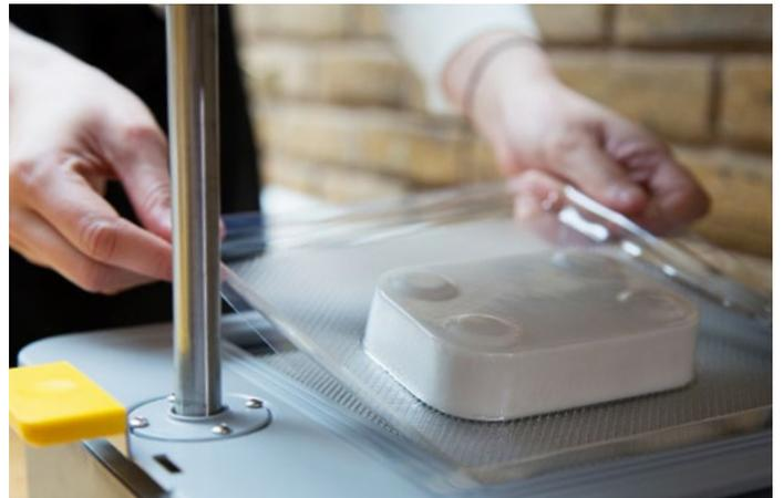
“Durch den 3D-Druck eines Master-Modells und die Erstellung einer zweiteiligen 3D-Form mit der FormBox konnten wir effizient eine Reihe von Seifenschalen erstellen, die perfekt auf die Bedürfnisse des Kunden zugeschnitten sind.”
